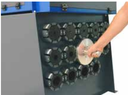
Inserire l'utensile nella serie di morsetti prescelta
