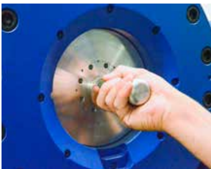
Chiudere la macchina per inserire tutti i morsetti contemporaneamente
