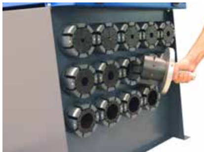
Ruotare e togliere la serie di morsetti
