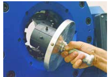
Inserire l'utensile con morsetti nella testa di pressatura
