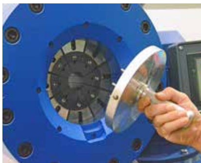
Sfilare Impugnatura cambio rapido
