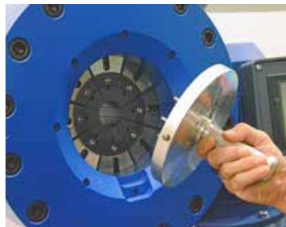
Der Handgriff des Schnellwechselwerkzeug herausziehen
