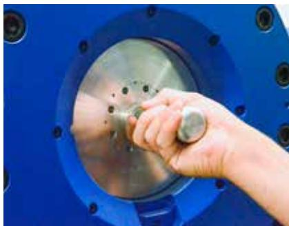
Die Maschine schließen, um alle Presbacken gleichzeitig einzuführen
