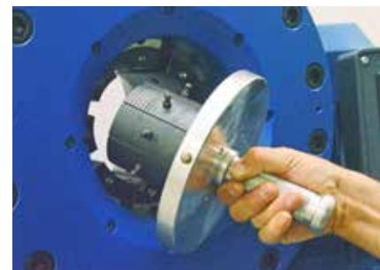
Das Werkzeug mit der Backensatz in die Presskopf einführen
