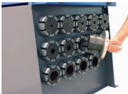
Ruotare e togliere la serie di morsetti
