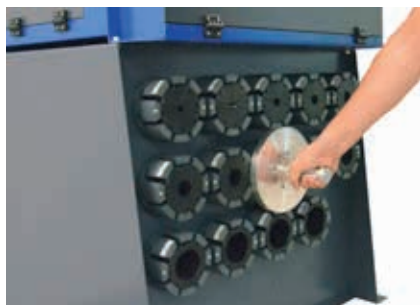
Inserire l'utensile nella serie di morsetti prescelta
