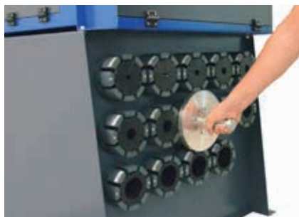
Inserire l'utensile nella serie di morsetti prescelta
