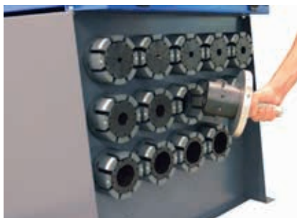
Ruotare e togliere la serie di morsetti
