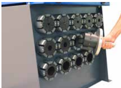
Ruotare e togliere la serie di morsetti
