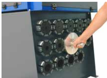
Inserire l'utensile nella serie di morsetti prescelta
