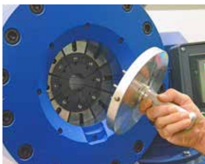
Sfilare Impugnatura cambio rapido
